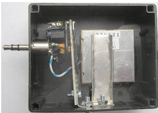
Bild 11: Einbau des U-Reglers und des EM-411
