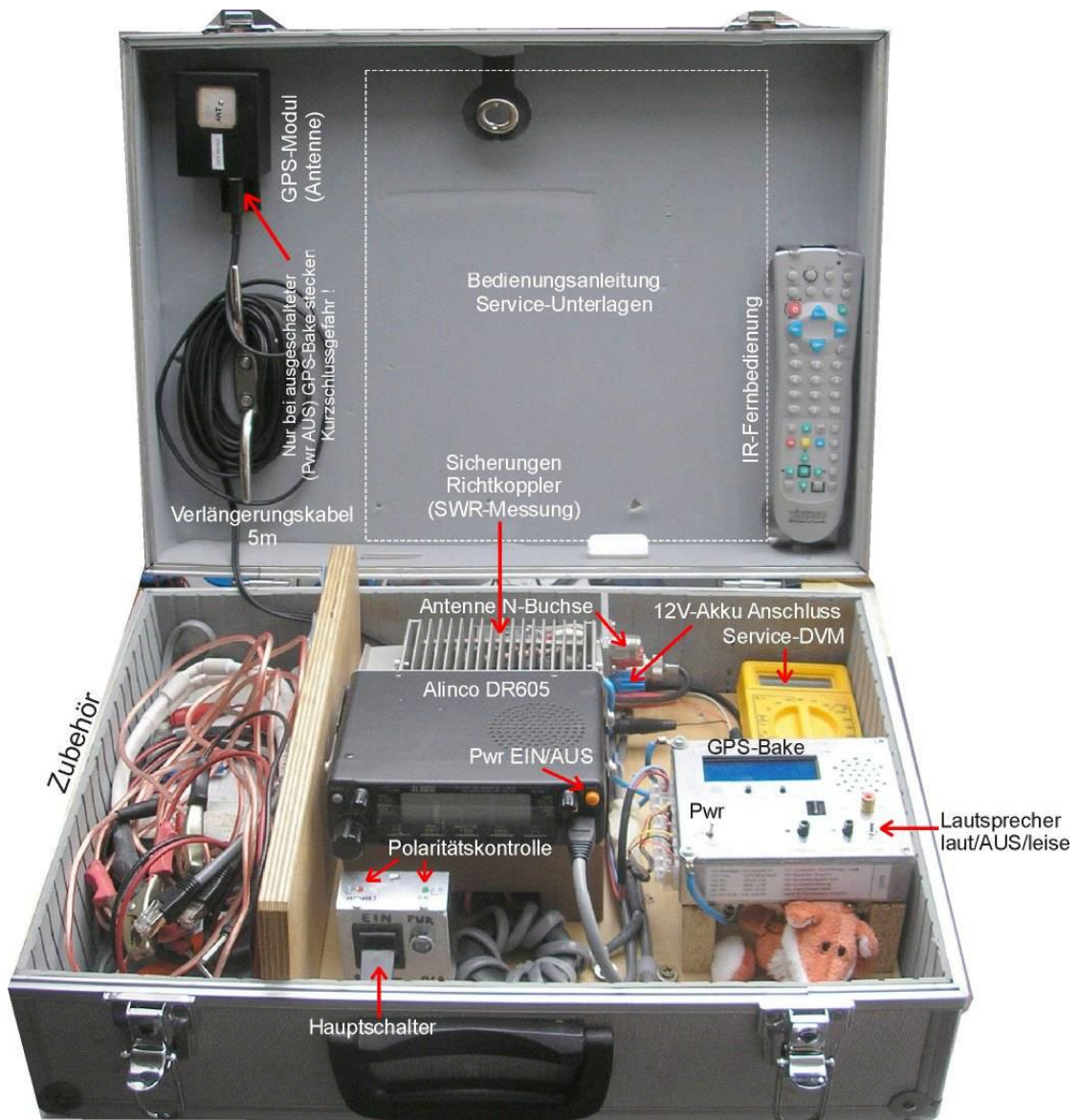
Bild 1: Der GFJ-Koffer mit Twin-Band-Transceiver, GPS-Bake, GPS-Modul und Fernbedienung
